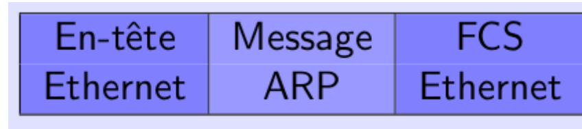
figure 5.9 Encapsulation d'un message ARP dans une trame ARP
