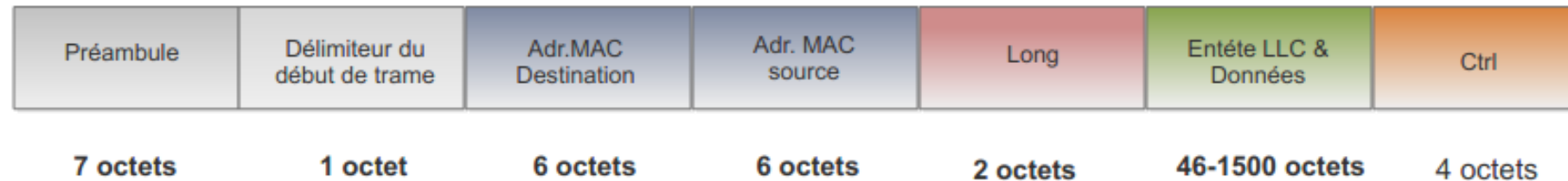
figure 4.8 Comparaison entre les trames Ethernet I et Ethernet II
